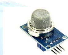
Fig: Gas sensor
